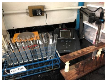
Figura 3.18. Medición con el electrodo. El pH que se lee en la pantalla es de 8.90.
